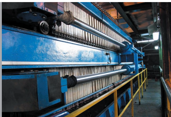
Фильтр-пресс SALA с мембранными и комбинированными камерными плитами 1500 x 1500 мм.
