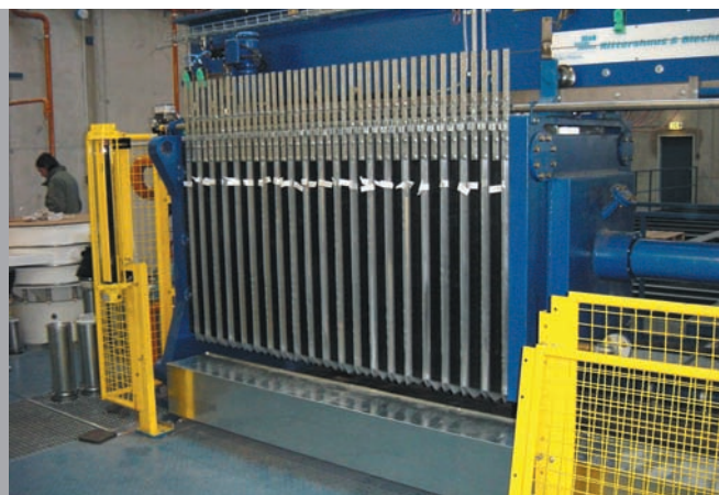
Фильтр-пресс с мембранными и комбинированными камерными плитами 1200 x 1200 мм. Фильтрация металлопигментов с растворителями
