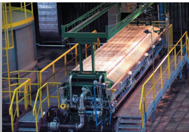
Фильтр-пресс с мембранными и комбинированными камерными плитами из PVDF (поливинилиденфторид) 1200 x 1200 мм.
