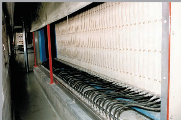
Фильтр-пресс для высушивания кека с мембранно-камерными плитами 1200 x 1200 мм
