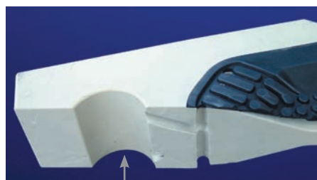
Отверстие для стока фильтрата
